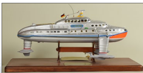
Modell des Tragflügelbootes WSS 25 (Studie nach Ing. Friedrich Hermann Wendel, 1958). (Foto: Silke Wiedmann/DSM)
