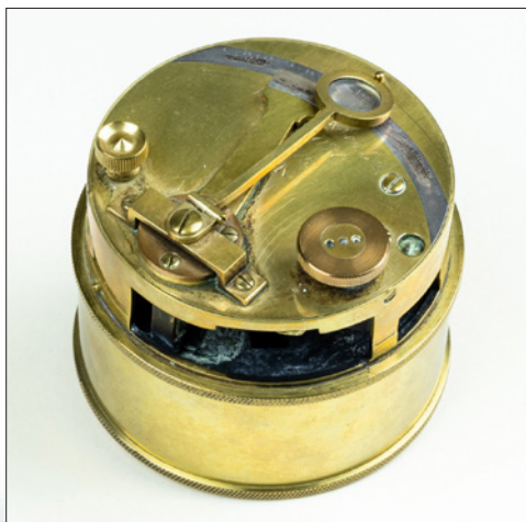
Schrägsicht des Dosensextanten (Inv.-Nr. I/08989/00 Pos. 77) mit vorderem Gehäusefenster, Zeigerarm und Ableselupe. (Foto: Helena Grebe/DSM)
