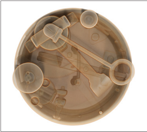
Virtuelles 3D-Modell des Dosensextanten von oben. Auch die inneren Bauteile sind deutlich zu erkennen. (Grafik: Pia Götz, MAPEX Universität Bremen)
