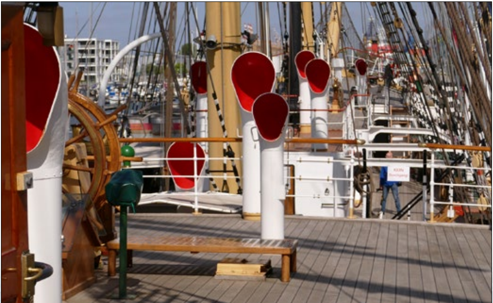
Windhutzen auf SCHULSCHIFF DEUTSCHLAND, hier eingefangen mit Blick vom Heck zum Bug. (Foto: Bernd Schumann)
