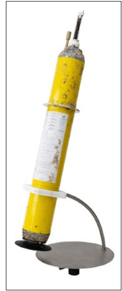
Argo-Float, frühes 21. Jahrhundert. Leihgabe des GEOMAR Helmholtz-Zentrums für Meeresforschung, Kiel. (Foto: Helena Grebe/DSM)
