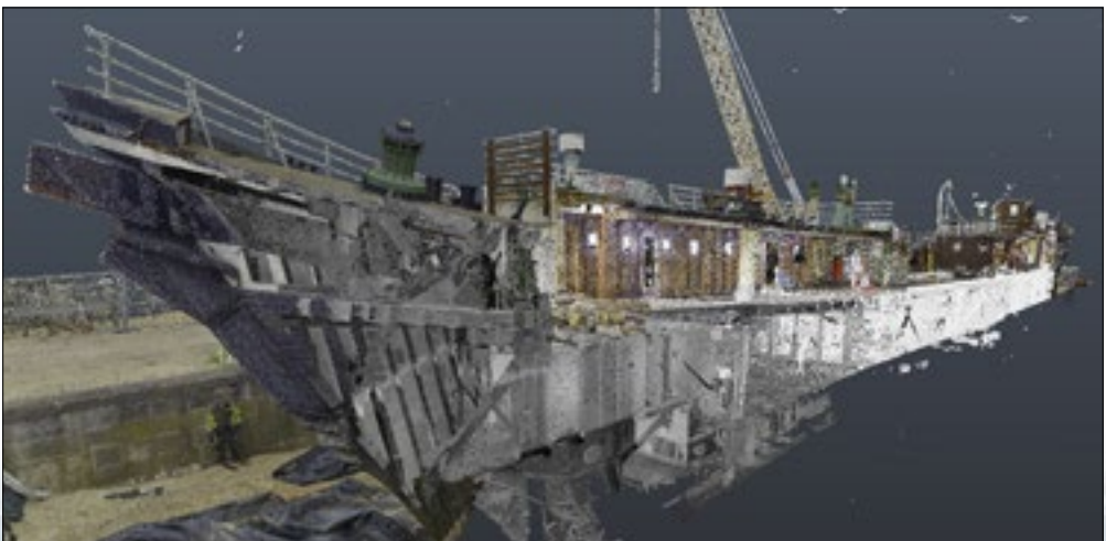
Scan vom Querschnitt der SEUTE DEERN. (Foto/Scan: denkmal3D)
