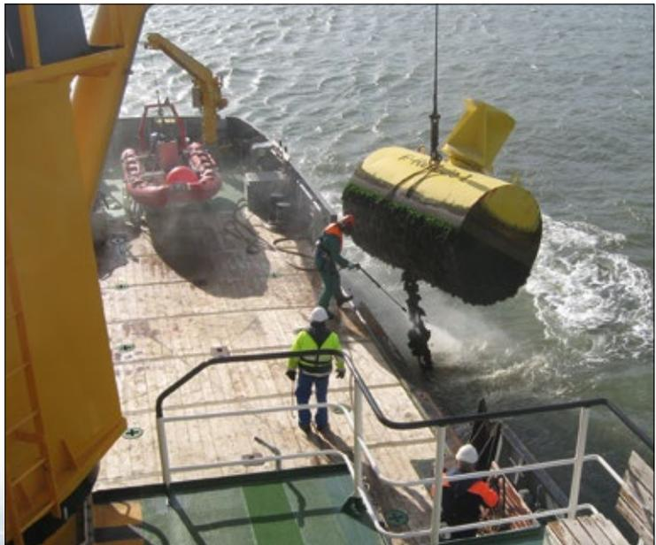
Die Tonne F-Reede 1 wird von Bewuchs gereinigt.
