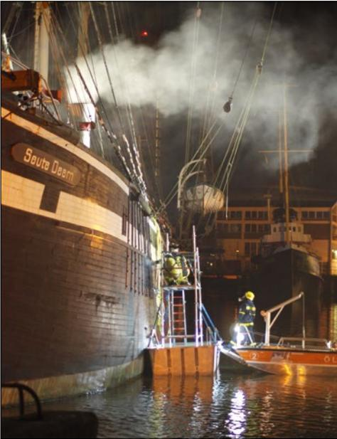
Von der Wasserseite aus trieben Feuerwehrleute sogenannte Fognails in die Backbordbeplankung.
