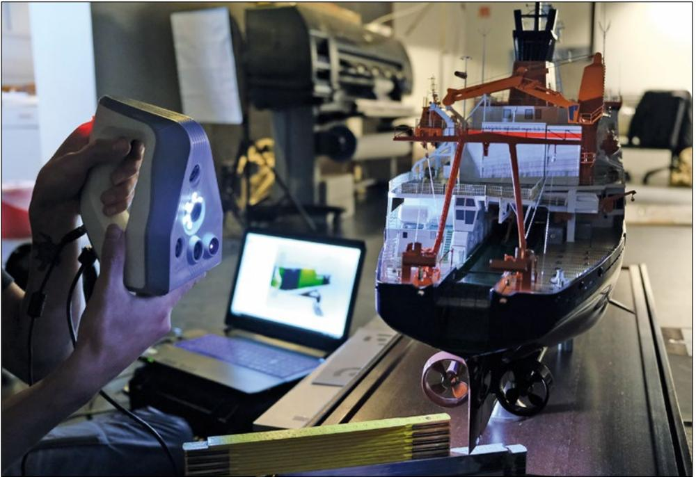
Mit dem Handscanner wurde ein CAD-Modell erstellt, das eine Bearbeitung des Digitalisats ermöglicht. Trotz eines intensiven eintägigen Grob- und Feinscans konnten nicht alle Schiffsdetails erfasst werden. Ein zweimonatiger Nachbearbeitungsprozess war daher nötig, um die Fragmente am Digitalisat zu entfernen bzw. zu überarbeiten. (Foto: Niels Hollmeier/DSM)
