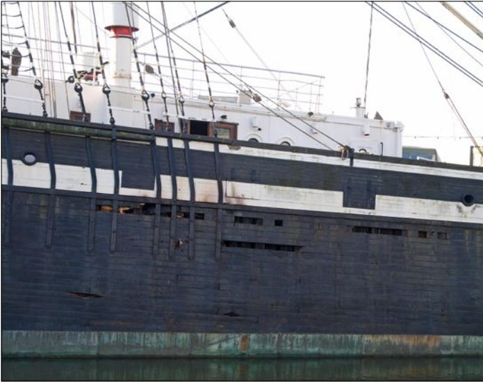
Auf den ersten Blick scheinen sich die Schäden in Grenzen zu halten, da die Feuerwehr bei der Öffnung der Beplankung vorsichtig zu Werke ging. Bei näherem Hinsehen lässt sich aber bereits erahnen, wie es hinter der Bordwand aussehen dürfte (bei Redaktionsschluss lagen noch keine Unter-Deck-Aufnahmen vor).
