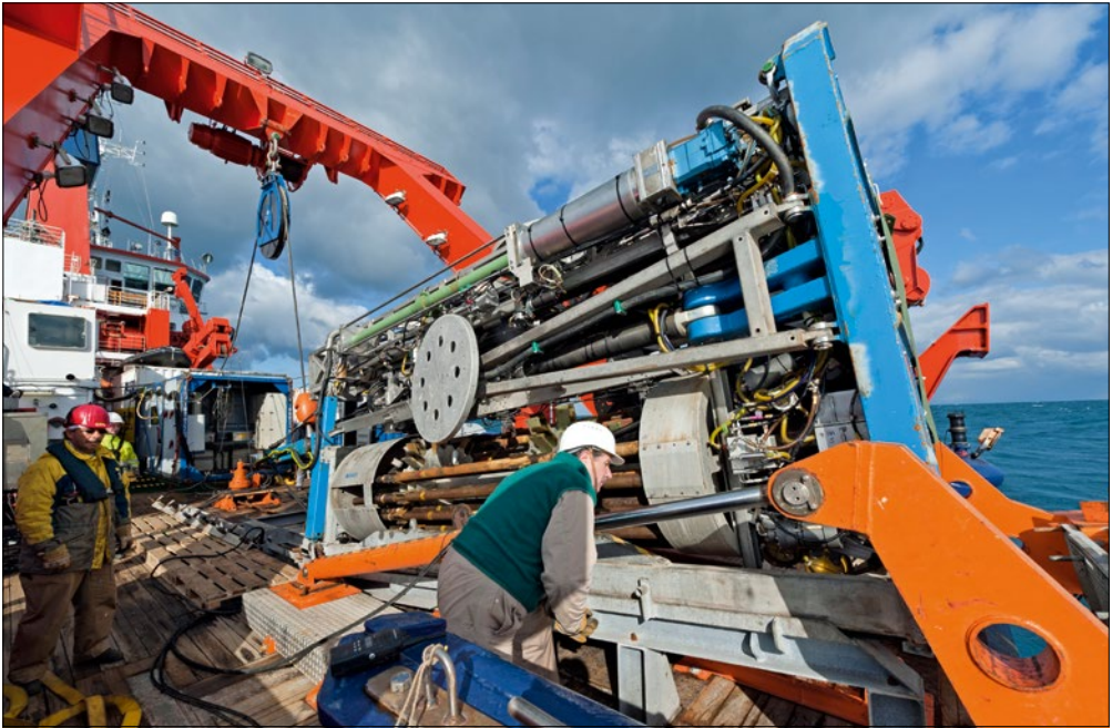
Das am MARUM entwickelte Meeresbodenbohrgerät MARUM-MeBo an Deck des Forschungsschiffes. (Foto: © V. Diekamp, MARUM)
