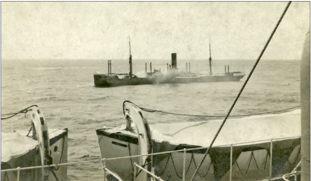
Dieses Bild zeigt neben den Schäden auf dem Vorschiff auch die Zerstörung der Aufbauten vor dem Schornstein der TARGIS.
