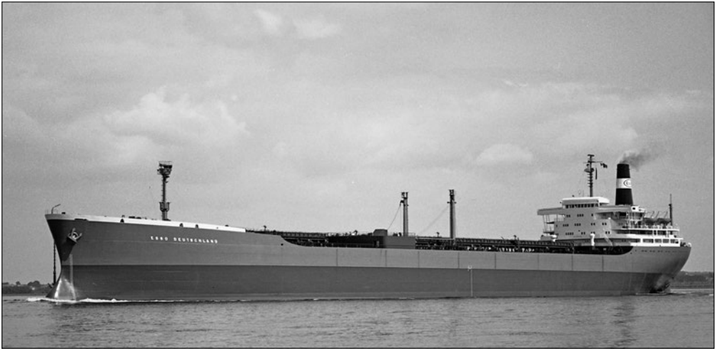
Auf dieser Aufnahme vom 11. August 1965 ist der ein Jahr zuvor nachgerüstete Wulstbug gut zu erkennen.
