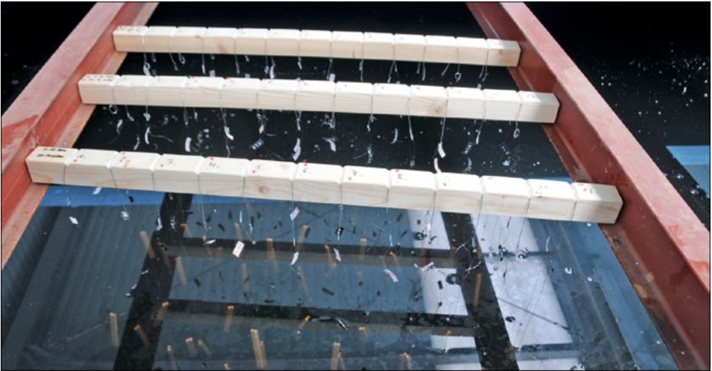
Auf Tauchstation: Die Proben, an denen mögliche holzersetzen­de Prozesse frühzeitig abgelesen werden können.
