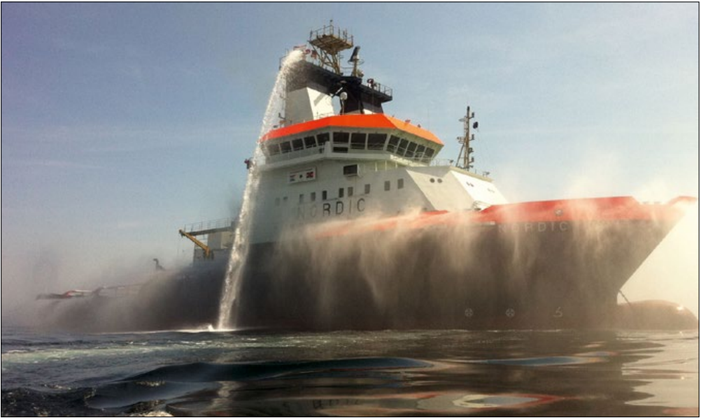
Mit einem dichten Wasservorhang kann sich der Notfallschlepper NORDIC bei einem Löscheinsatz vor der Hitze des Brandherdes schützen. (Alle Fotos zu diesem Beitrag: Besatzung der NORDIC)
