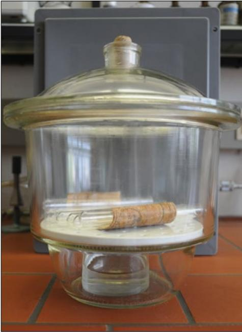
Der Versuchsaufbau zur alkoholischen Plastifizierung: Die Birkenrinde wird durch Ethanolämpfe und leichte Gewichte nach und nach in eine Planlage gebracht.
