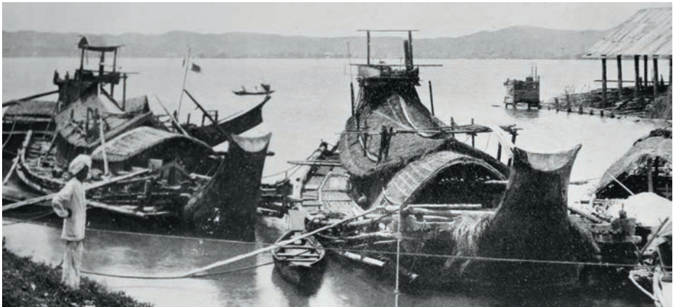
Abb. 10 Die burmesischen Reisboote, von Frau Rosenberger vielfach bewundert, bestachen durch ihre eleganten Linien. Die größten konnten bis zu 150 Tonnen Reis transportieren und hatten eine Besatzung von etwa 20 Mann. Auffallend war die Außengangway der decklosen Schiffe. (Aus: Hornell 1946)
