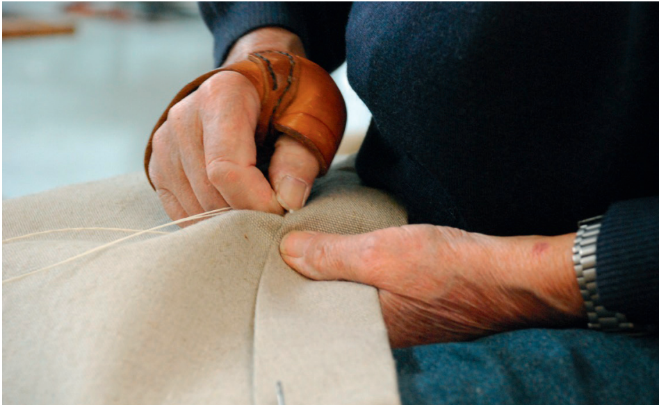
Abb. 7 Ein Segelmacherhandschuh, der für Liekarbeiten vorgesehen ist, weist eine Verlängerung über dem Daumen auf, über die das Nähgarn stramm durchgesetzt werden kann. (Foto: Inger Smedsrud, Norsk Håndverksinstitutt/Norsk Handverksutvikling)
