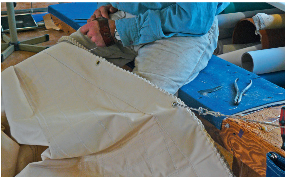
Abb. 6 Annähen eines Lieks an der Außenkante des Segels, das sogenannte Einlieken. Mit einer verhältnismäßig stumpfen Nadel wird durch die Keepen der Kardeele genäht. Ein gleichmäßiges Stichbild entsteht, wenn so tief in den Saum eingestochen wird, wie ein einzelnes Kardeel an Durchmesser aufweist. Der hier abgebildete Segelmacher ist Linkshänder; ein rechtshändiger Segelmacher würde das Liek von der rechten Seite her annähen. (Foto: Inger Smedsrud, Norsk Håndverksinstitutt/Norsk Handverksutvikling)
