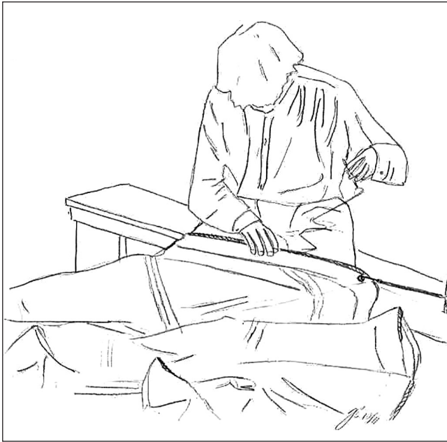
Abb. 10 Das Einlieken, auf einer Segelmacherbank sitzend. Indem das Segeltuch zwischen dem Bankhaken (rechts) und dem von diesem abgewandten Knie (vom Betrachter aus links) durch Abwinkeln des Knies vom Bankhaken weg in seiner Spannung reguliert werden kann, kann die Profiltiefe beim Nähen des Segels justiert werden. Das Strammen des Fadens von bereits angenähten Liektauen weg oder hin trägt ein Übriges zum Profilieren des Segels bei. (Zeichnung: Verf.)
