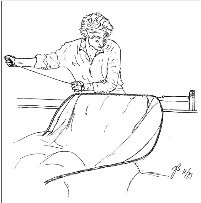
Abb. 12 Beim Nähen auf der Bank leistet der kleine eiserne Bankhaken, gemeinsam mit dem fest montierten Pflock (rechts im Bild), wichtige Dienste. Die Abbildung zeigt den Pflock der Segelmacherbank eines Linkshänders; für einen rechtshändigen Segelmacher wäre der Bankhaken an der rechten Seite montiert. (Zeichnung: Verf.)
