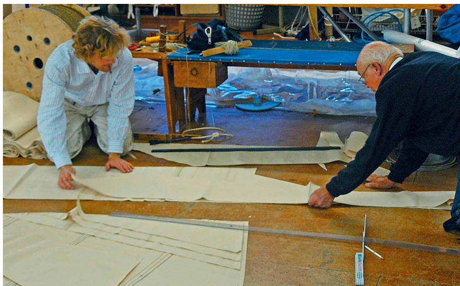
Abb. 4 Zuschneiden eines Bolten. Im Bildvordergrund sind auf der Segelecke drei verstärkende Tuchlagen eines Bolten, in unterschiedlichen Größen zugeschnitten, erkennbar. Der Deckbolten, d.h. die oberste Tuchlage des Bolzens, die später im Segel sichtbar ist, wird gerade zugeschnitten. (Foto: Inger Smedsrud, Norsk Håndverksinstitutt/Norsk Handverksutvikling)
