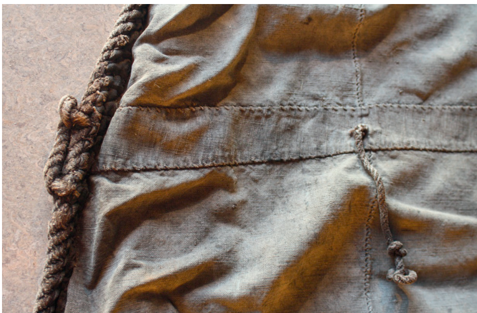
Abb. 2 Ein aufgesetzter Tuchstreifen, ein Reffband, an einem Rahsegel eines norwegischen Gebrauchsbootes. (Foto: Verf.)
