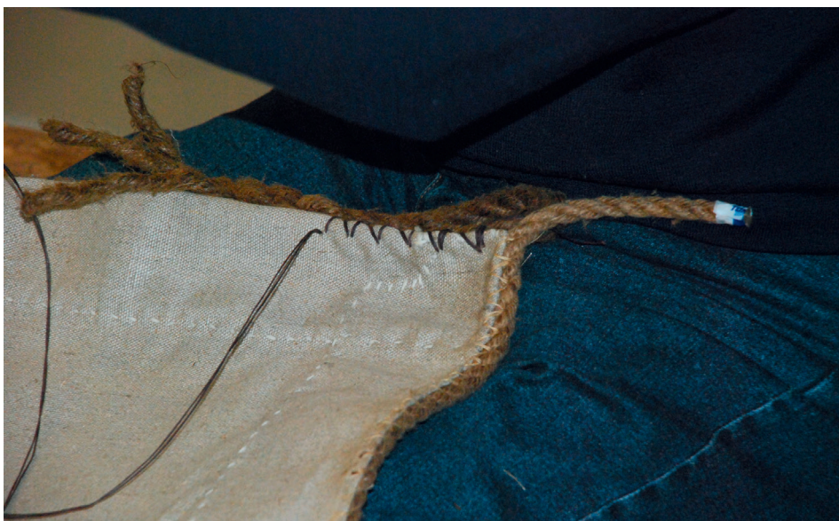
Abb. 8 Kreuz- oder Konterstiche werden dort ausgeführt, wo eine besonders feste Verbindung zwischen Liektau und Segeltuch erforderlich ist: an den Segelecken, dort, wo Gattchen aufgesetzt werden (bei Tuchkleidnähten etc.). Kreuzstiche entstehen, wenn zweimal durch dieselbe Keep genäht wird. (Foto: Inger Smedsrud, Norsk Håndverksinstitutt/Norsk Handverksutvikling)
