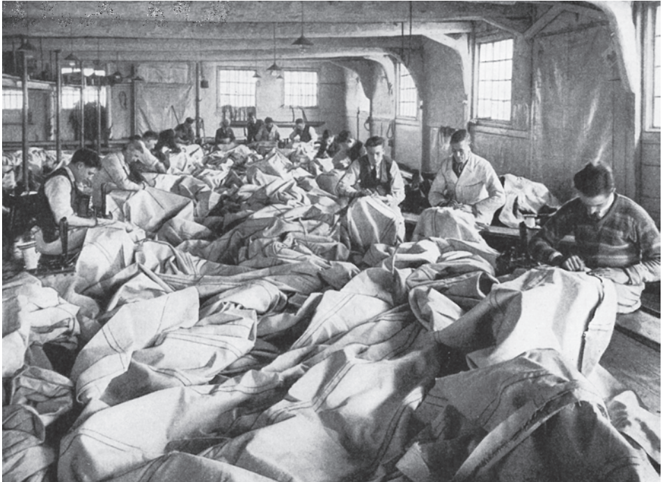
Abb. 15 Obwohl die Nähmaschine im 20. Jahrhundert im Gewerk gut etabliert war, wurden auch in der modernen, gleichwohl traditionellen Segelmacherei viele Arbeiten von Hand, auf den Segelmacherbänken sitzend, ausgeführt. (Aus: Grohmann 1937, S. 106)
