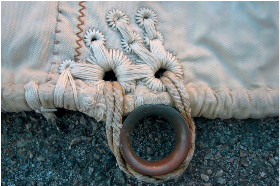
Abb. 27 Sternförmig eingesetzte Gattchen, die mit Brückenbändseln miteinander verbunden sind und die Kräfte, die in der Rundkausch zu wirken kommen, ins Segel übertragen; der Segelmacher spricht von einer sogenannten »Brille«, hier an einem Großsegelreff. (Foto: Verf.)
