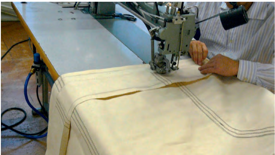
Abb. 21 Ein falscher Saum wird auf die Achterkante eines Baumwollsegels genäht, eine Technik, die vor allem bei Yachtsegeln verbreitet war. Gut erkennbar ist die eingestrichene Kante des falschen Saums, die beim Annähen unter den Saum geklappt wird. (Foto: Inger Smedsrud, Norsk Håndverksinstitutt/Norsk Handverksutvikling)
