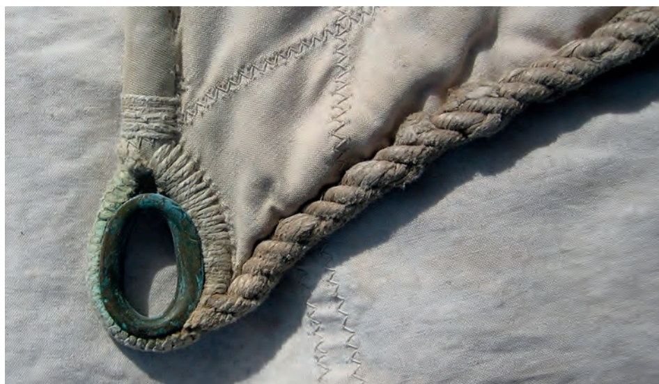
Abb. 24 Das Halsauge eines Yachtvorsegels aus Baumwolle. In den Saum des Vorlieks (links) wurde ein Drahtliek eingenäht, dessen Auge von Segeltuch und Garn umschlossen und in eine ovale Kausch eingesetzt wurde. Das Unterliek hingegen wurde mit einem Hanftauwerk versehen, welches am Auge mit einem Pünt verjüngt wurde. Verglichen mit den Techniken des modernen Segelmachens, bei dem Kauschen hydraulisch eingepresst und gewebte Tuchbänder als Verstärkung eingenäht werden, beansprucht diese Ausführung einiges mehr an Zeitaufwand, und an handwerklicher Könnerschaft. (Foto: Verf.)
