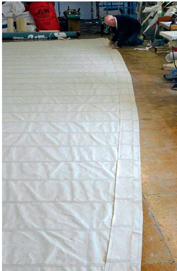
Abb. 18 Eine eingerichtete oder »abgeschlagene« Achterkante eines Großsegels. Der Tuchüberstand, der beim Zuschnitt stehen gelassen wurde, ist nun abgeschnitten, die Achterkante des Segels kann eingestrichen und besäumt (mit einem Saum versorgt) werden. (Foto: Inger Smedsrud, Norsk Håndverksinstitutt/Norsk Handverksutvikling)
