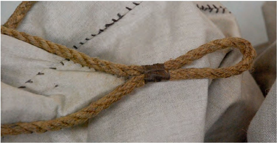
Abb. 25 Die einfachste Form des Schothorns, hier an einem kleinen Segel: Das Liek wird als Bucht an der Ecke des Segeltuches herumgeführt und mit einem Kneifbändsel zusammengesetzt. (Foto: Inger Smedsrud, Norsk Håndverksinstitutt/Norsk Handverksutvikling)
