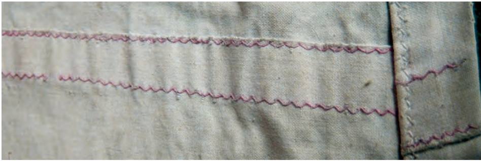
Abb. 5 Ein Abnäher, an diesem Baumwollsegel erkennbar als eine leicht keilförmige Verbreiterung der Naht, der zwei Tuchkleider miteinander verbindet. (Foto: Verf.)
