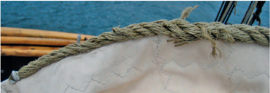
Abb. 1a–b Zwei Pünts, oben ein Pünt aus Hanf, unten aus einem Polypropylen-Tauwerk. Während der Pünt im Hanftau auch nach Jahren des Gebrauchs anständig aussieht, fasert das deutlich gröbere Kunstfasertauwerk bereits an einem neuen, nahezu ungebrauchten Segel aus. (Fotos: Verf.)
