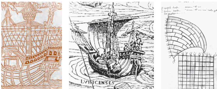
Abb. 34–36 Unterschiedliche Arten der Vernähung der Segelbahnen sind überliefert: links venezianischer Segler, Mitte nach Olaus Magnus' »Carta Marina«, rechts nach Michael von Rhodos.
