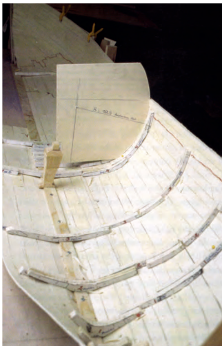
Abb. 13 Lemée ermittelte an einem der B&W-Wracks 10,5 Amsterdamer Fuß als immer wiederkehrenden Wert des Radius eines Winkels zur Bestimmung des Hohls. (Aus: Lemée 2006, S. 185)
