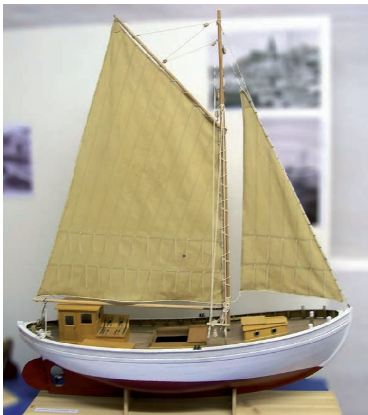
Abb. 65 Modell im Maßstab 1:15 eines Motorkut- ters, Typ S5. (Foto: Helmut Olszak)
