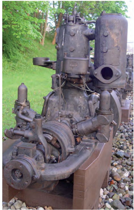
Abb. 50–51 12-PS-Deutz-Glühkopfmotor. (Fotos: Helmut Olszak)
