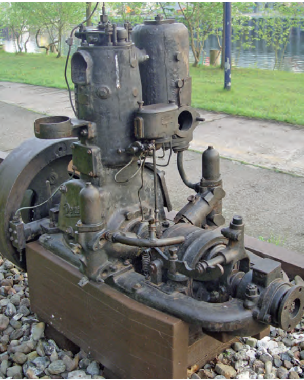
Abb. 50–51 12-PS-Deutz-Glühkopfmotor. (Fotos: Helmut Olszak)
