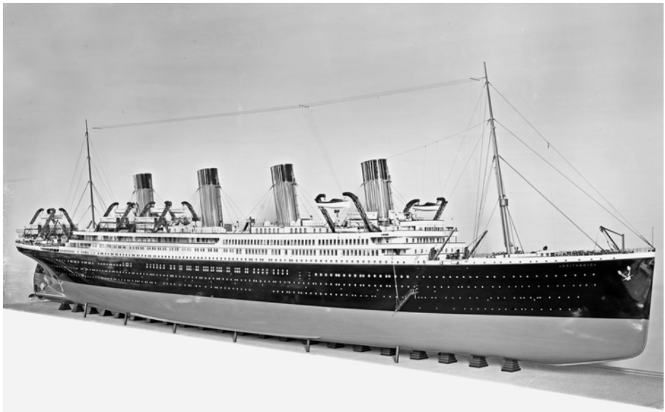
Abb. 15 Modell der BRITANNIC mit der ursprünglich vorgesehenen Aufstellung der optisch auffälligen Gitterdavits. Kriegsbedingt wurde das Schiff aber als Lazarettenschiff mit dem vorgeschriebenen Rotkreuzanstrich fertiggestellt. Die im Modell dargestellten beiden Davitpaare auf dem Achterschiff fielen dabei weg. (Ulster Folk and Transportation Museum, Belfast)
