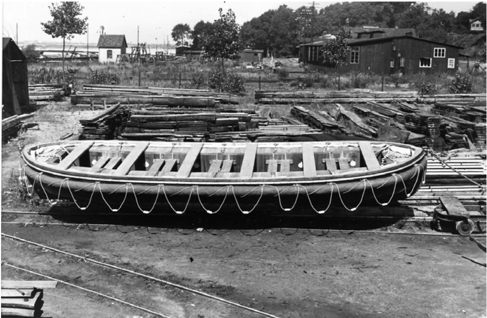
Abb. 18 Ein 1913/1915 bei Havighorst in Diagonalbauweise aus Eiche erbautes Halbklappboot (Maße 9,15 x 2,90 x 0,70 m), dessen Seitenwände aus Segeltuch nicht ausgefahren sind. (Slg. Heinz D. Janssen, Ganspe)
