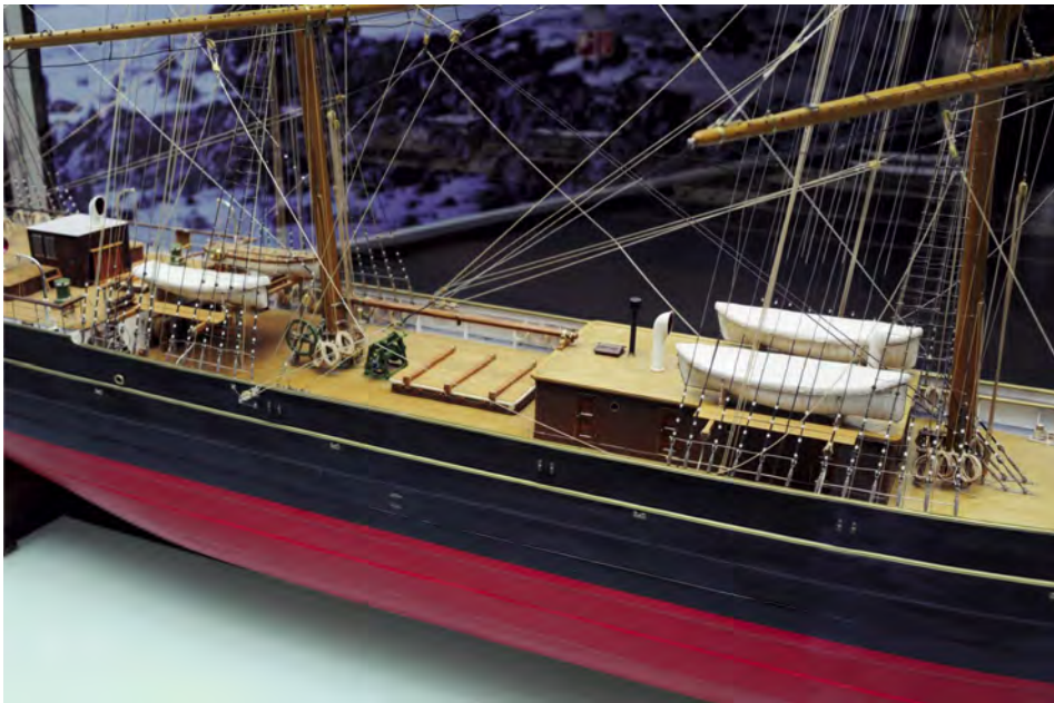
Abb. 5 Bootsaufstellung auf der eisernen Hamburger Bark AURORA (1883, 1076 BRT). Modell im Deutschen Schiffahrtsmuseum. (Foto: Egbert Laska, DSM)
