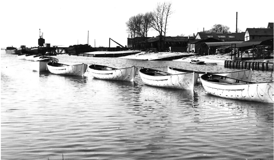
Abb. 19 Aufgereiht vor der Werft Havighorst in Rönnebeck liegen 1921 sieben 26-Fuß-Rettungsboote, die aus Stahlblech der Werke in Thale/Harz gefertigt wurden. (Slg. Heinz D. Janssen, Ganspe)
