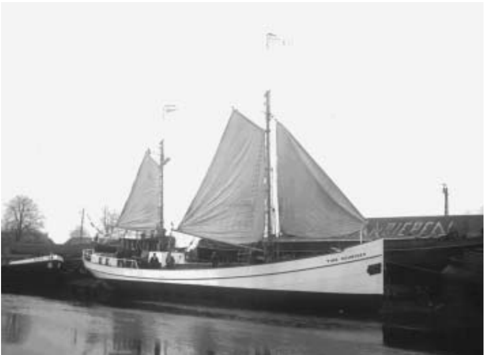
Abb. 3 Bestellt am 23. Januar und abgeliefert am 18. April 1929: die TINE SCHRÖDER, eine kleine Schwester der späteren JUTLAND, mit 25,20 x 5,60 Meter. Der Schiffsrumpf wurde bei Brandsma in Franeker gebaut. Seit 1986 fährt die TINE SCHRÖDER als MADRAQUE in der niederländischen Charterfahrt.
