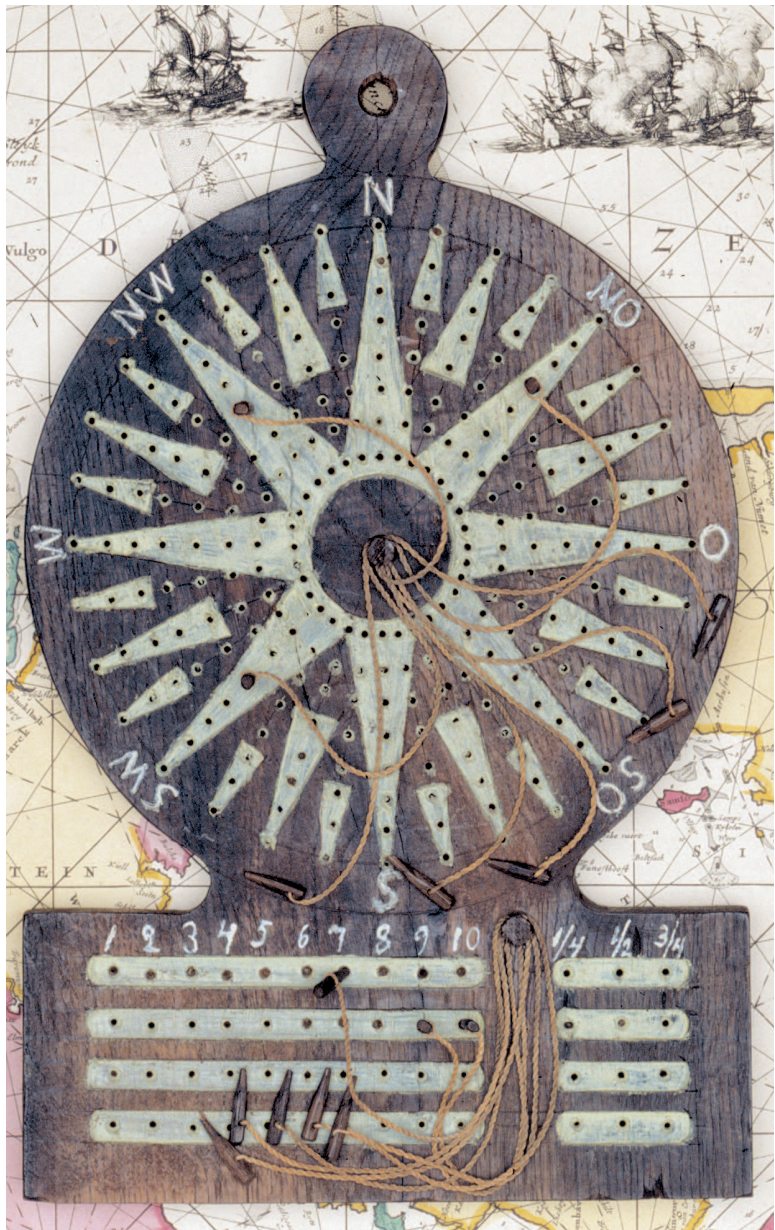
Abb. 18 Traversbord oder Pinnkompass. Auf ihm wurden halbstündlich die gesteuerten Kurse und stündlich die gelogten Geschwindigkeiten mit den Holzspinnchen eingesteckt, um nach Wachwechsel ins Journal eingetragen zu werden. Material Holz, Abmessungen: 35,6 x 23,3 cm, Materialstärke 2 cm. (Foto: Archiv DSM)
