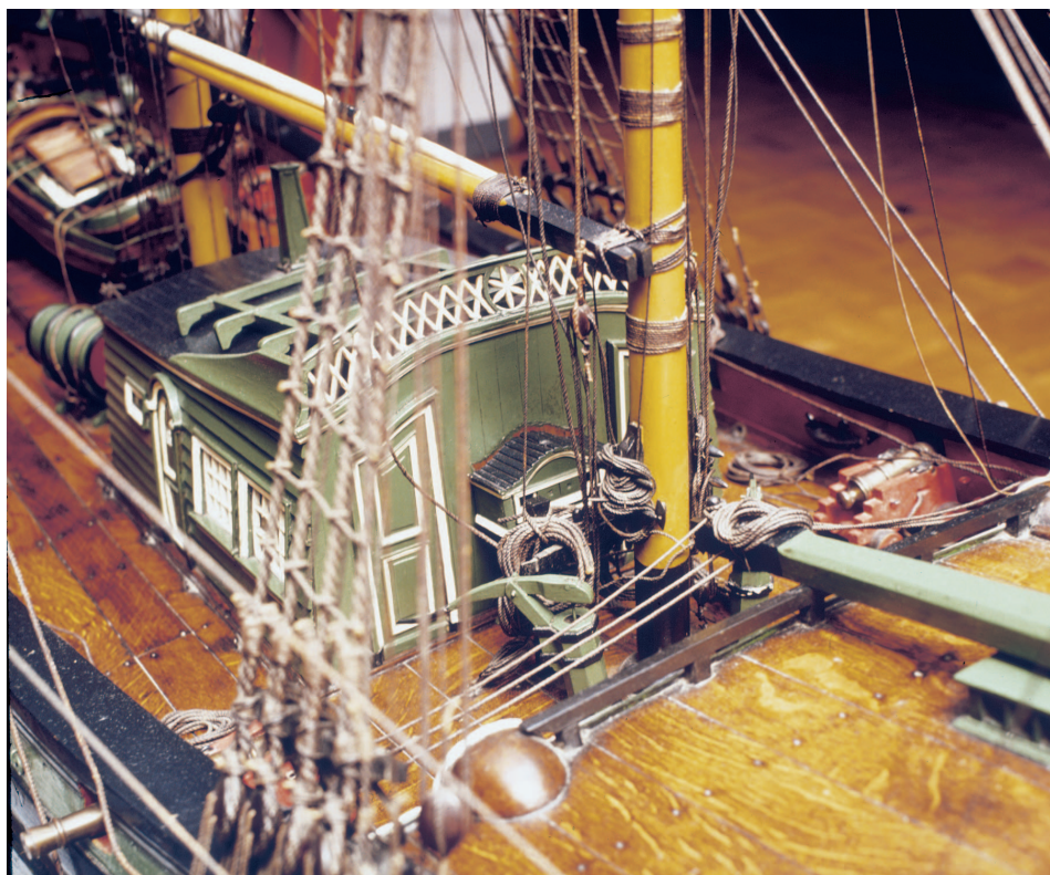
Abb. 14 Foto vom Achterdeck eines Modells einer Dreimastgaliot aus dem 18. Jahrhundert. Man erkennt deutlich die im Text beschriebene Anordnung der Pumpen beiderseits des Besanmastes sowie ihr Aussehen. Achterkante Deckshaus befindet sich das Kompasshäuschen, in dem sich auch Sanduhren befanden. Dass der Kompass vom Rudergänger nicht gesehen werden konnte, spielte keine Rolle. Er sollte keinen Kompasskurs steuern, sondern seinen Kurs nach dem Leelik des obersten stehenden Rahsegels. Über das Hüttendeck läuft die Ruderpinne mit ihren Taljen. (Foto: Nationaal Scheepvaartmuseum, Antwerpen)
