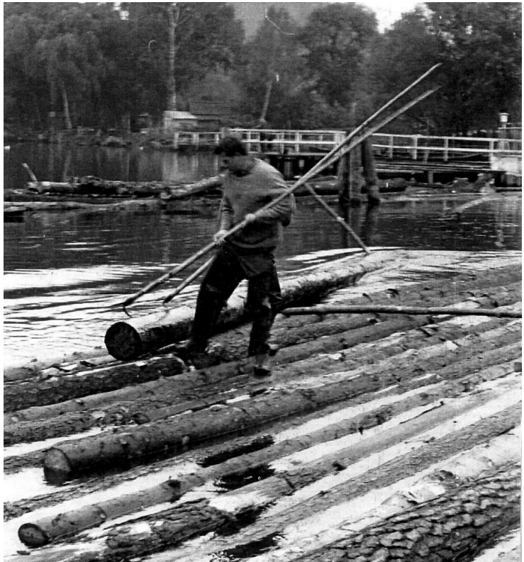
Abb. 9-10 Flößer des Flößereibetriebes Hans Schenke O.H.G. Bernöwe bei Einbindearbeiten an einem Floß, um 1965. (Fotos: Sammlung Eberhard Seelig)
