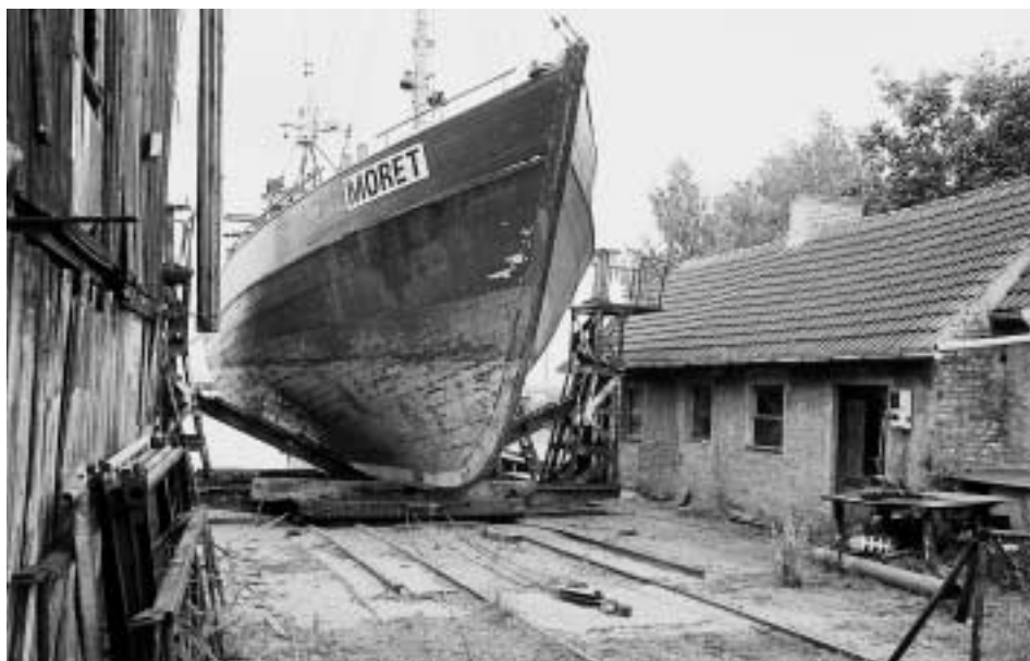
Abb. 9 Ein zum Angel- und Ausflugs-kutter umgebauter 17-m-Kutter auf der Slipanlage der Jarling-Werft in Freest, 2004.
