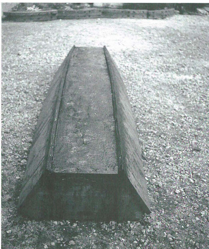
Abb. 2 Frisch geteert ist der neue Trog zur Ablieferung fertig. Erkennbar stehen die Außenkanten der Seitenplanken über der Bodenfläche über und schützen so die empfindliche Nahtstelle zwischen Boden und Seitenborden.
