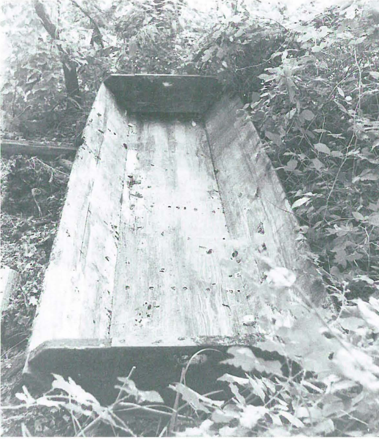
Abb. 4 Ursprünglich hatte ein Trog im Bootsinneren keine Einbauten wie Spanten und Duchten.
