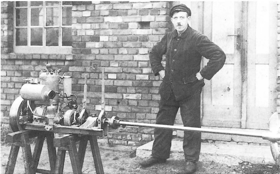
Abb. 32 Arthur Paeschke vor seiner Hafenschmiede in Freest, mit einem neugebauten Glühkopfmotor von 5 PS (1936).
