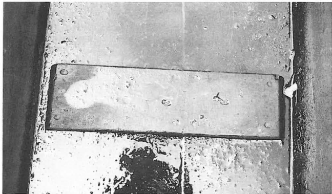
Abb. 15 Wrange des Würzburger Fischerschelchs mit durch das Wasser deutlich erkennbarer Nagelung.
