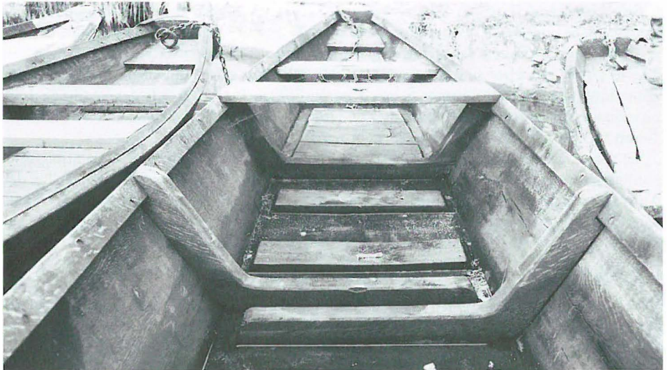
Abb. 13 Zwei zu einem Paar zusammengefaßte Spanten, die mit Abstand zweinander stehen und im Wechsel zu den Seiten nach oben gehen. Die verstärkenden Bordleisten werden von den Spantköpfen umfaßt.
