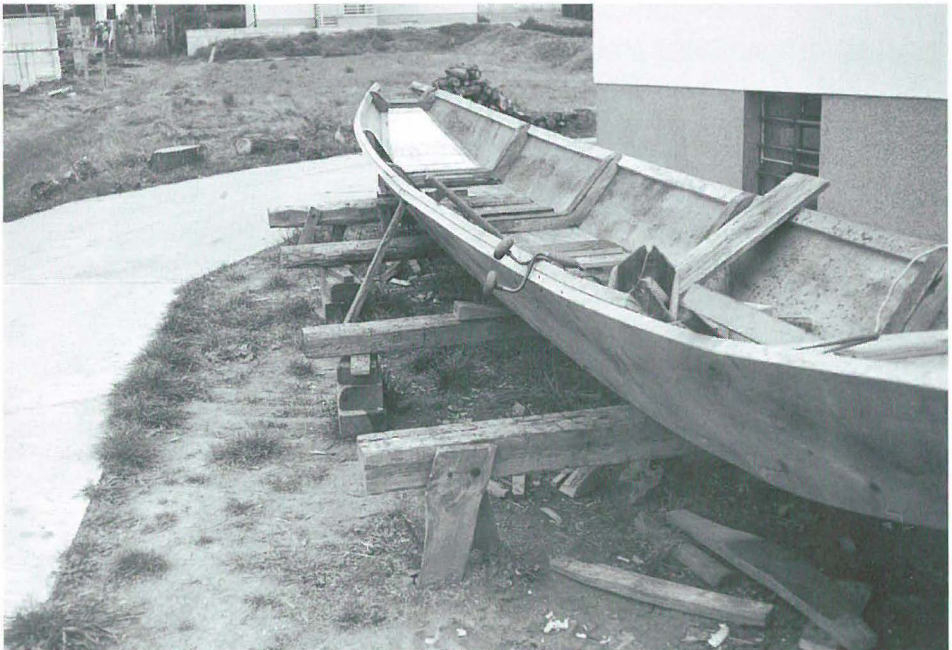
Abb. 19 Lagerbock des Bootsbauplatzes in Knetzgau. In den Boden eingelassene Balken halten den waagerechten Querbalken, auf dem der Bootsboden befestigt ist.
