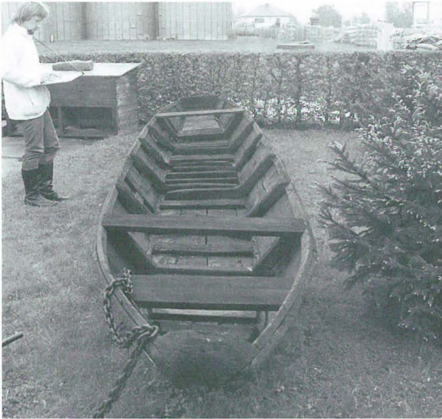
Abb. 12 Typische Spant- und Wrangenanordnung eines oberländischen Schelchs in Haßfurt.
