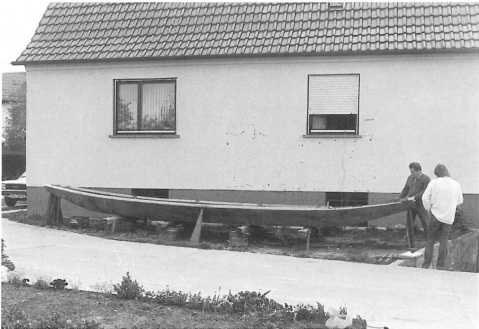
Abb. 20 Der einfache Bootsbauplatz des Schelchbauers Franz Betz hinter seinem Wohnhaus in Knetzgau. Neben den beiden festen Lagerböcken sind zwei weitere, lose Lager zu sehen. Sie werden aus aufeinandergeschichteten Holzklötzen und ein quer darüber gelegtes Vierkantholz gebildet.
