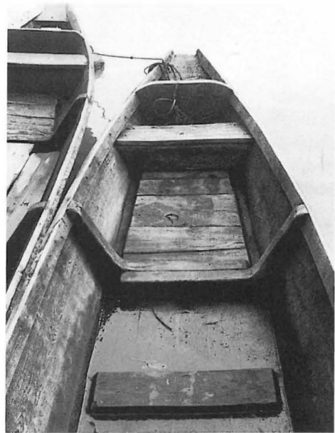
Abb. 10 Kist des Fischerschelchs in Erlach bei Lohr an der hinteren Bootsheb.
