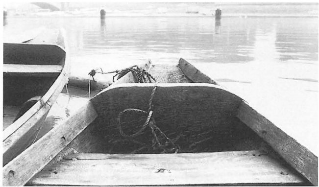
Abb. 8 Ruderbank im Bereich der hinteren Heb eines Fischerschelchs.
