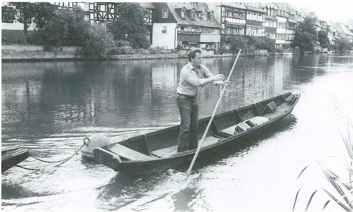
Abb. 6 In der hinteren Heb verkürzter und mit einem kleinen Spiegel abgeschlossener Fischerschelch in Bamberg. In typischer Weise setzt sein Besitzer zur Fortbewegung des Bootes den Fahrbaum ein.
