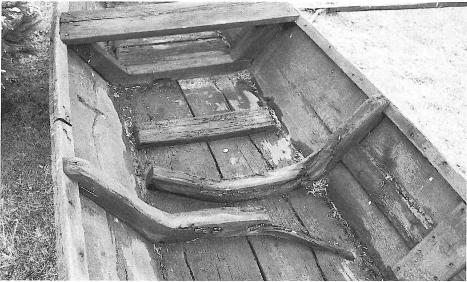
Abb. 14 Spanten aus gewachsenem Krummholz bei einem Schelch in Haßfurt.
