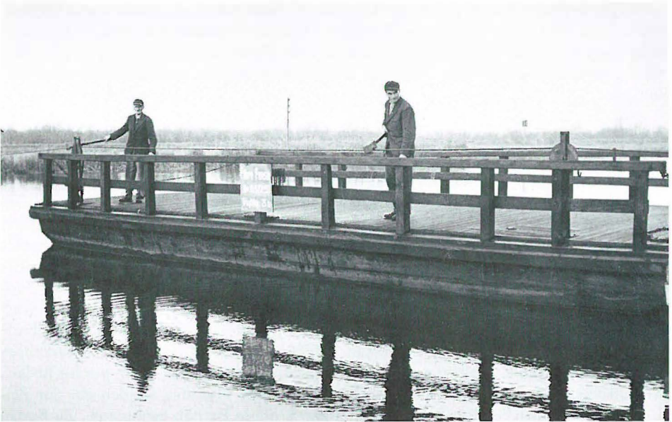
Die Wirtschaftsfähre Pensin über die Peene wurde mit einem Seilzug mit Handbetrieb angetrieben. (Archiv SMR)
