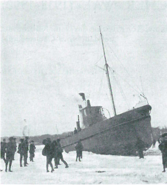
Abb. 1 Der Schleppdampfer DARMSTADT (250 PSi) des Kaiserlichen Kanalamtes beim Eisaufbruch im Winter 1895. (Aus: Görz und Buchheister: Das Eisbrechwesen im Deutschen Reich, 1900, S. 63)
