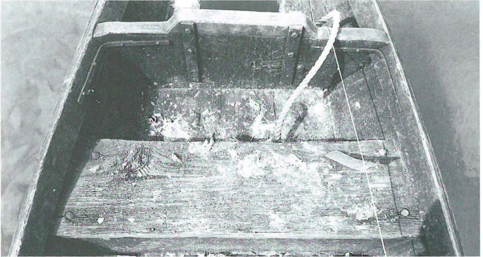
Abb. 15 Ruderbank mit gedoppeltem Boden in der hinteren Heb (Ausschnitt aus Abb. 16).
