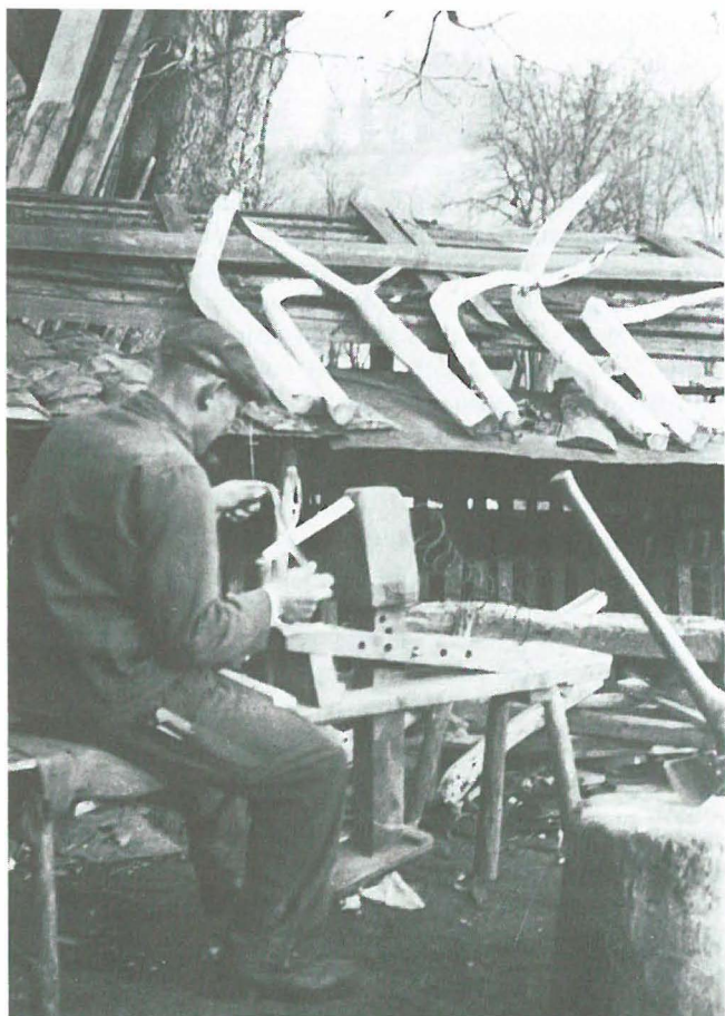
Abb. 1 Mit dem Ziehmesser werden die Holznägel zugeschnitten.
