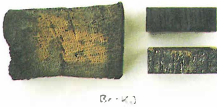
Abb. 1 PEG-Nachweis durch Besprühen des Holzes mit kreidehaltiger Brom-Kaliumjodidlösung. Rechte Seite: zwei Spaltheilften mit Brom-Kaliumjodid besprüht; oben ohne Kreide, unten mit Kreide.
