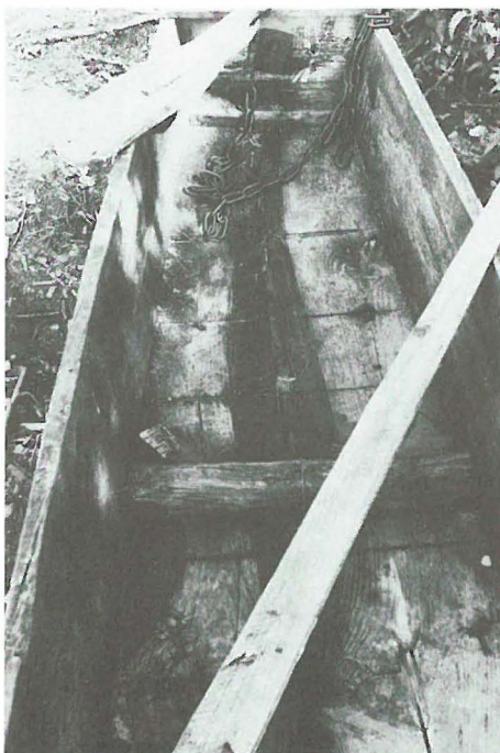
Abb. 8 Der Boden im Bugteil des Bootes mit deutlich erkennbaren Quereinschnitten, die das Biegen der Planken erleichtern sollten (aus dem Dorf Borucino).
