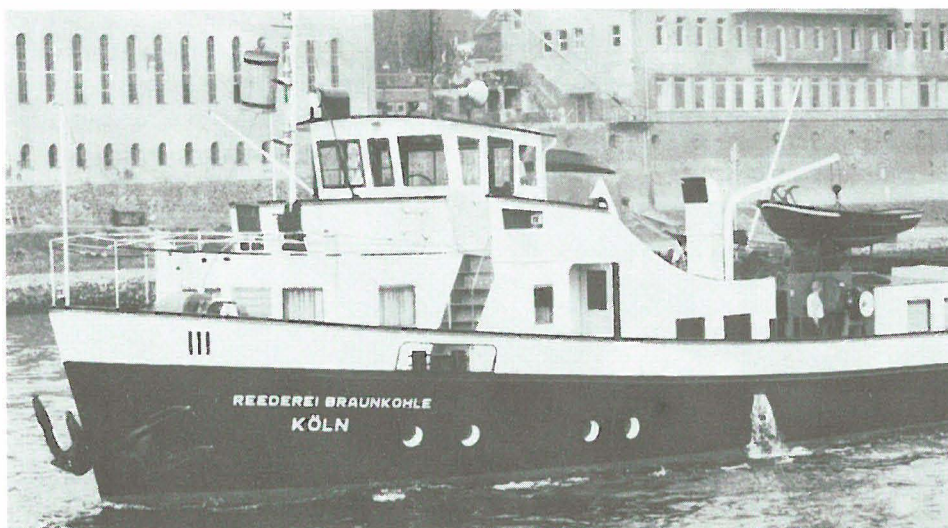
Motorschlepper werden im Trend der sechziger Jahre mit schräg abfallendem Steven gebaut.
