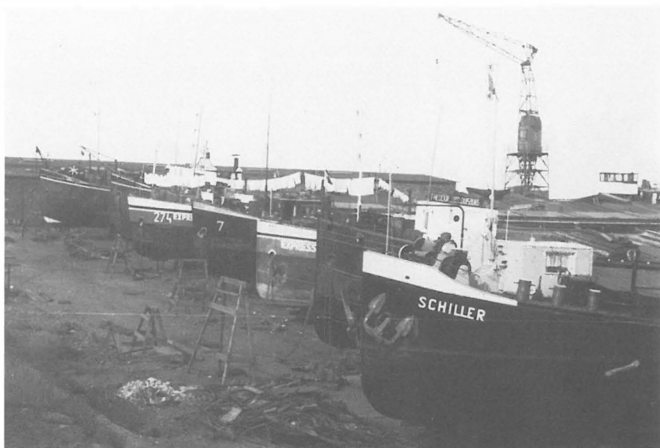
Schleppkähne und Motorschiffe auf der Triton-Schiffswerft in Ruhrort 1966: Bugformen, wie sie fast ein halbes Jahrhundert das Bild auf dem Rhein bestimmt haben.
