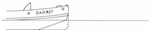
Die Bugform der PAILOT nach dem Umbau (vor dem Umbau gestrichelte Linie) (Zeichnung Verfasser)
