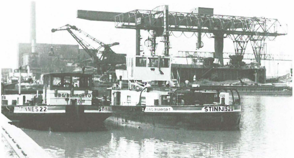
Abb. 15 Koppelverband im Hafen Dortmund 1980. (Foto: Verf.) Links der Kahn, rechts das Motorschiff im Dortmunder Hafenbecken A (Unionhafen); im Hintergrund das Sinterwerk der Dortmunder Stahlwerke Hoesch/Estel.
