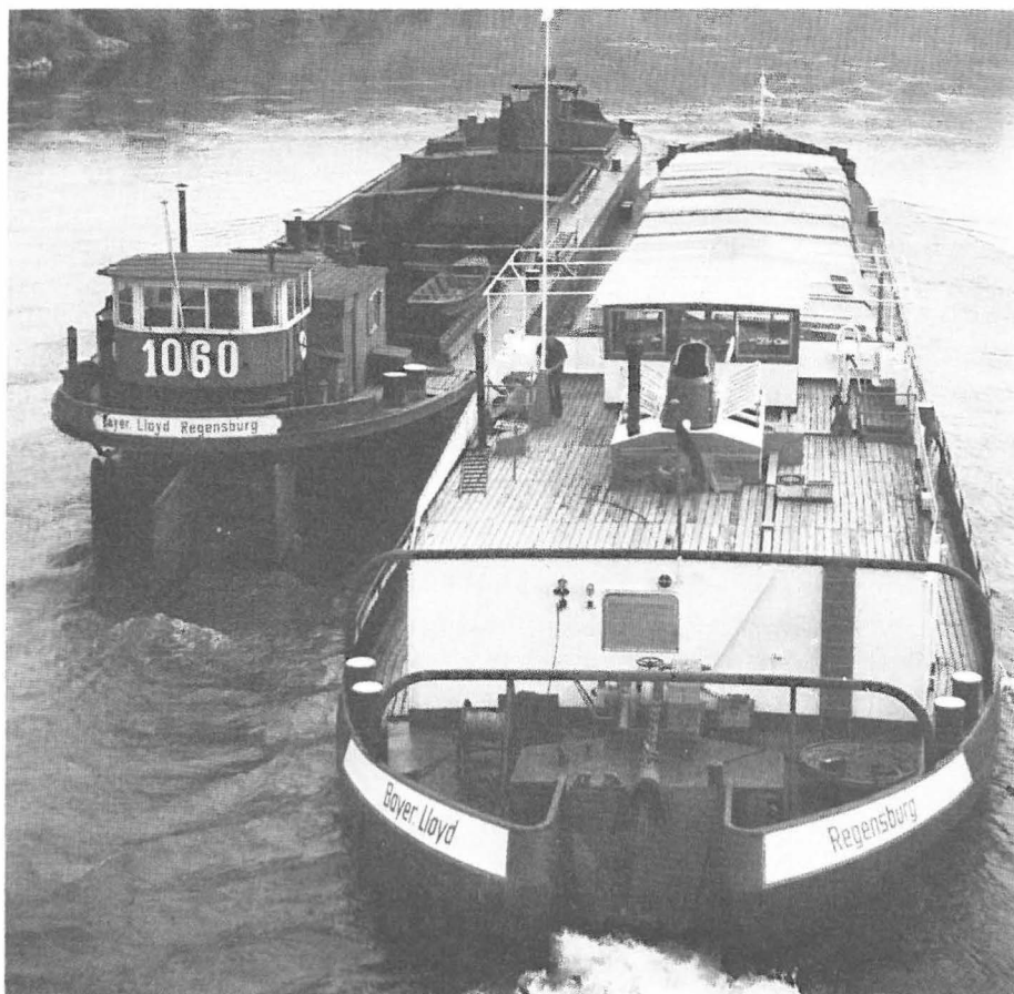
Abb. 20 Beischlepp-Verband auf der Donau. (Foto: Bayerischer Lloyd) Ähnlich wie auf dem Rhein versucht man auf der Donau mit der Methode des Schleppens von Kähnen durch Selbstfahrer die Betriebsform der Schifffahrt zu rationalisieren.
