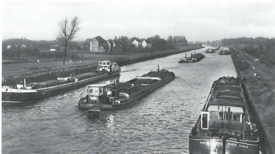
Abb. 25 Kanalschifffahrt bei Datteln am DEK um 1958. (Foto: Cramers Kunstanstalt, Dortmund) Noch Ende der fünfziger Jahre gehörten lange Schleppzüge zum gewohnten Bild auf den Kanälen. Im Bildmittelgrund zwei Kähne von der Elbe, links ein kleines Motorschiff, MER VII, ebenfalls aus dem Elbegebiet. Rechts im Bild MS MARIA aus Haren/Ems, ein Peniche-Typ, an sich auf französischen und belgischen Wasserstraßen beheimatet (wegen ihrer geringen Tragfähigkeit wurden die Schiffe billig veräußert, und manch ein Harener Schiffer nutzte diese Gelegenheit und machte sich selbständig).
