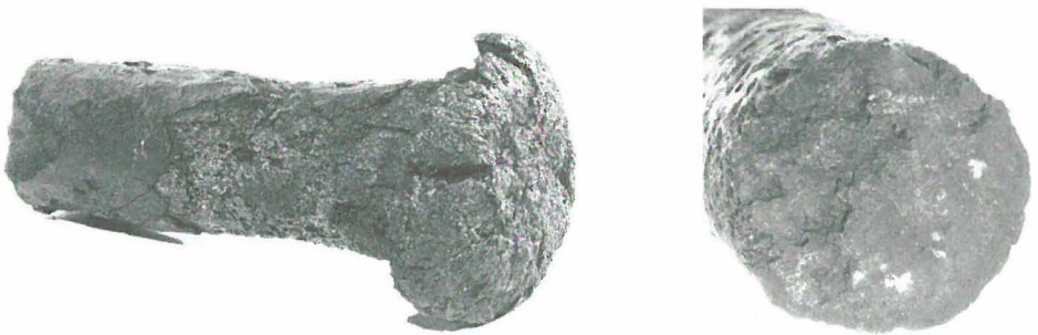
Abb. 2 (links) Gestauchtes Kopfende des gebrochenen Bolzens. (Foto: Laska, DSM)
