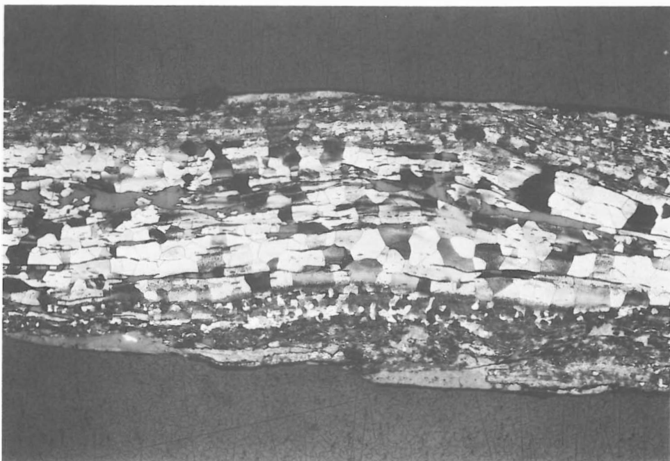
Abb. 6 Gefüge über dem Querschliff von Klammer A. (M. 40:1; Ätzung: wässer. Ammonpersulfatlösung).
