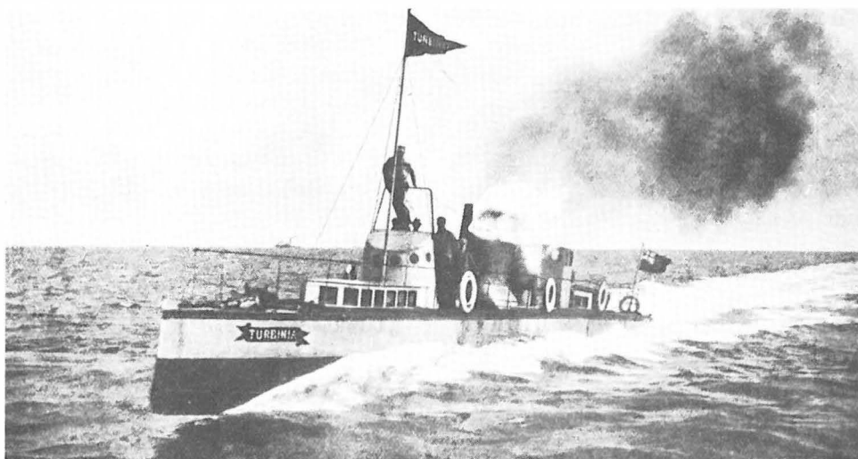
Das erste Turbinenschiff, die von Parsons erbaute „Turbinia“, Länge des Schiffs 100', Wasserverdrängung 44 1/2 t, Anlage mit 3 Propellerwellen zu je 3 Propellern, max. Geschwindigkeit 33 – 34 kn, erbaut 1897 (Foto: Neilson, The Steam Turbine , 1903).
