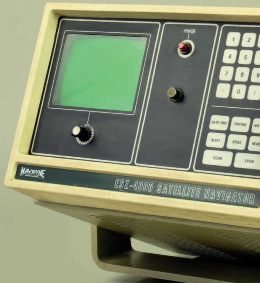
Satellite Navigator, Modell ESZ-4000, hergestellt von Navidyne Corp., USA, ca. 1980.
