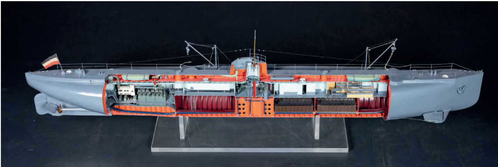
Modell des Handels-U-Bootes DEUTSCHLAND, teilweise als Schnittmodell gestaltet.
