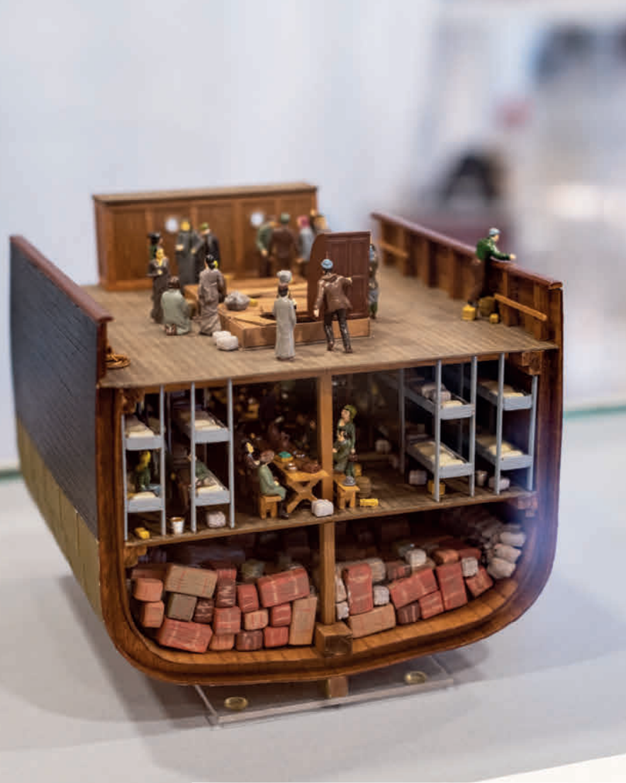
Querschnittmodell eines hölzernen Auswandererseglers um 1850.
